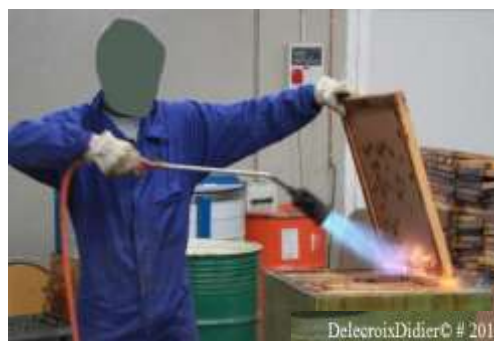
Pour travailler vite et bien, choisissez « un chalumeau puissant, installé sur une bouteille de 13kg de butane mais de préférence de propane si vous travaillez en extérieur ». Photo : Delecroix. Source : www.apiservices.com/rfa/articles/chalumeau.htm .
